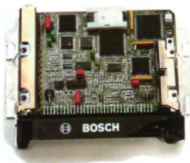
A figura ao lado apresenta uma unidade de comando com sistema de injeção e ignição integrados, do tipo digital.
